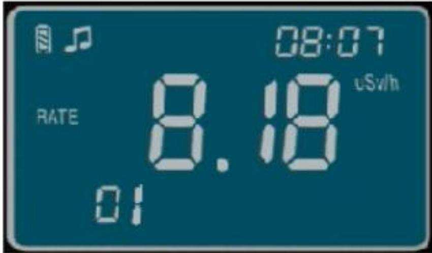
第一行显示的时本次报警时间；第二行显示的是报警剂量率和单位；第三行显示当前查询的是第几组数据。继续按“下键”查看下一组报警数据，循环查询。当查询到的报警数据为“0.00”时，表示当前组没有报警存储数据。
